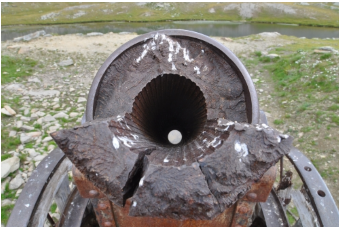
Volata spezzata. Si vede la rigatura della canna. Foto: Natura - I tredici laghi Il lago Rametta o lago dei cannoni - Lou laou Ramëtto ou di canoun Prali Pralv (pralymania.com)
